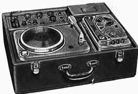
*E' un complesso destinato principalmente a costituire impianti mobili o autoportati di diffusione sonora, composto da un giradischi, un registratore, un amplificatore BF di potenza (che può alimentare fino a 4 trombe esponenziali N. 2570 oppure fino a 8 altoparlanti SP 200) ed un invertitore a vibratore per l'alimentazione con accumulatore tipo auto a 12 volt.*
