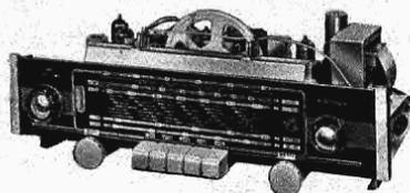
Con questo telaio, unitamente ad un complesso fonografico stereofonico N. 3005 e a due altoparlanti o coppie di essi (ad es. il mobile diffusore N. 3106) si possono realizzare radiofonografi di altissima qualità.
