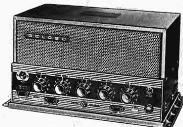
Ingressi per microfono e fono magnetico, fono a cristallo, radiosintonizzatore, TV-suono, registratore - Distorsione ed intermodulazione inferiori all'1% - Uscite da 3 a 250 ohm - Alimentazione con tensioni alternate da 100 a 250 V - Dimensioni cm 39 x 22 x 21 - Peso netto circa kg 12,500.
