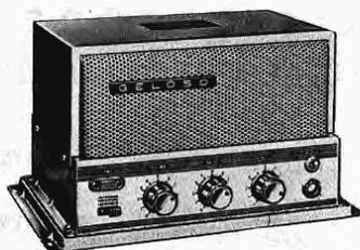
Ingressi per fono magnetico e per fono a cristallo, o registratore o sintonizzatore - Distorsione ed intermodulazione inferiori all'1% - Uscite da 3 a 24 ohm - Alimentazione con tensioni alternate da 100 a 250 volt - Dimensioni cm 33x18x19 - Peso netto circa kg 6,5.
