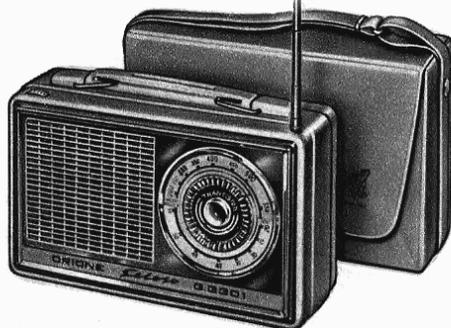
Riceve le onde medie e le onde corte con elevatissima sensibilità e grande potenza e qualità sonore. Le due antenne incorporate, a ferrite ed a stilo telescopico, consentono una ottima ricezione in qualsiasi condizione d'uso. Il mobile, con maniglia, è in materiale anti-urto, inalterabile.
