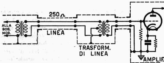
Quando la lunghezza della linea microfono/amplificatore supera un certo valore (di solito 10 metri) è conveniente usare una linea schermata di tipo bilanciato verso massa, a media impedenza, come mostra la figura qui a lato. Con ciò è possibile evitare l'attenuazione discriminata a seconda della frequenza, dovuta alla capacità di linea, e l'introduzione di rumori di fondo dovuti a campi esterni.
