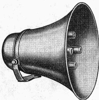
E' una tromba di grande potenza, per la sonorizzazione di aree anche molto estese (es. ippodromi, grandi campi sportivi, ecc.). Utilizza 4 unità N. 2567 collegabili in parallelo per un'impedenza complessiva di 4 ohm. Per lunghe linee si consiglia di usare il trasformatore di linea N. 5562, incorporabile nella tromba fra le quattro unità, con impedenze d'entrata (linea) 50 - 70 - 125 ohm.
