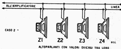
2) per altoparlanti in parallelo, tutti con diversa impedenza:
