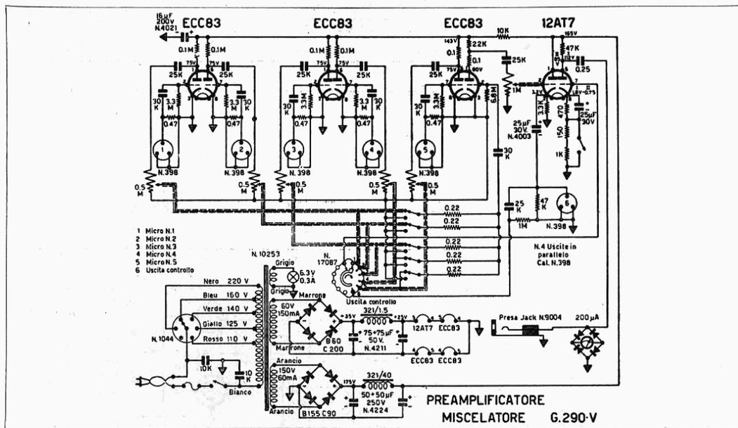
**Sensibilità** (per ciascun canale d'entrata, con tutti i regolatori di volume al massimo, rispetto ad un livello d'uscita di 320 mV): 4 mV (0,5 M $\Omega$ ).
