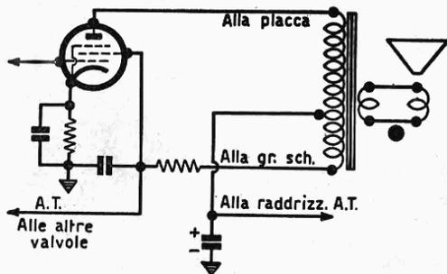
A sinistra — Schema generico d'impiego di un trasformatore per altoparlante con presa intermedia. Negli apparecchi radioricevitori moderni con stadio finale ad una sola valvola è spesso usato questo sistema per eliminare ogni residuo di rumore di fondo dovuto alla componente pulsante della corrente anodica ottenuta mediante raddrizzamento della corrente alternata.
