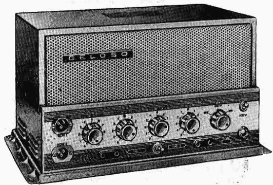
E' un amplificatore di media potenza ad alimentazione mista rete-accumulatore particolarmente adatto per impianti che richiedono la continuita' del servizio, anche in mancanza di energia elettrica di rete. Il passaggio dall'una all'altra forma di alimentazione e' rapidissimo. Alcune principali applicazioni: seggiovie e funivie, locali pubblici con distribuzione saltuaria di energia elettrica, autobus pubblicitari, ecc.
