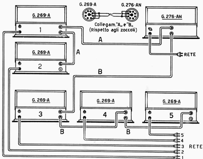
3 di un amplificatore dovrà essere collegato col morsetto 2 dell'altro ed alla massa comune; la linea di carico dovrà essere collegata al morsetto 2 del primo e al morsetto 3 del secondo amplificatore.
