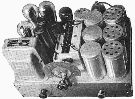
8 Valvole: una alta frequenza, una oscillatrice, una 1<sup>a</sup> rivelatrice, una media frequenza, una 2<sup>a</sup> rivelatrice, due pentodi.
