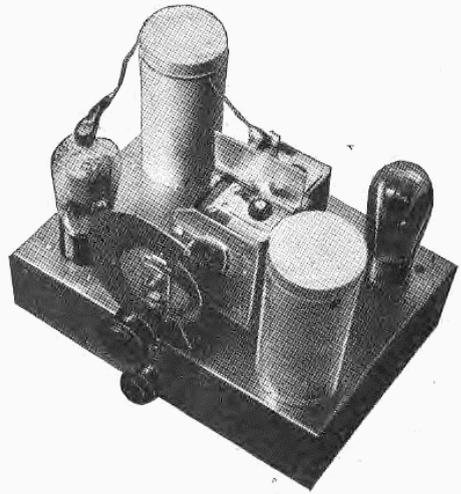
Il sintonizzatore visto di sopra : si noti lo schermo tra i compensatori dei condensatori variabili
