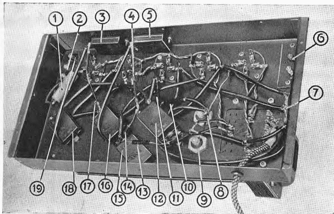
Fig. 3 - 1 cond. a cartuccia 0,015 - 2 morsetti del diaframma - 3 cond. 0,5 catodo 1a valv. - 4 resistenza V 2000 catodo 2a valv. - 5 cond. 0,5 catodo 2a valv. - 6 morsetti di uscita 70.0 ohms - 7 zoccolo del dinamico 8-9 cond. elettrolitico - 10 resistenza 10.000 ohm - 11 resistenza 25.000 ohm - 12 blocco 3x1 mf. - 13-14 resistenza 100.000 ohm - 15 cond. 1 mf. - 16 cond. 0,2 mf. - 17 resistenza V 2000 catodo 1a valv. - 18 cond. 0,1 19 resistenza 10.000 ohm.
