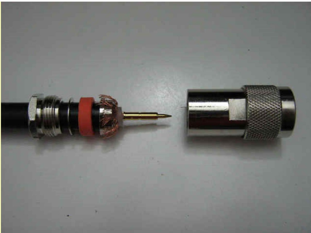
Infilare il corpo del connettore e avvitarvi il tappo filettato badando che il pin centrale esca correttamente. Stringere definitivamente il tappo utilizzando due chiavi esagonali, la calza verrà bloccata tra il corpo del connettore e la rondella assicurando il contatto elettrico e il bloccaggio meccanico del cavo.
