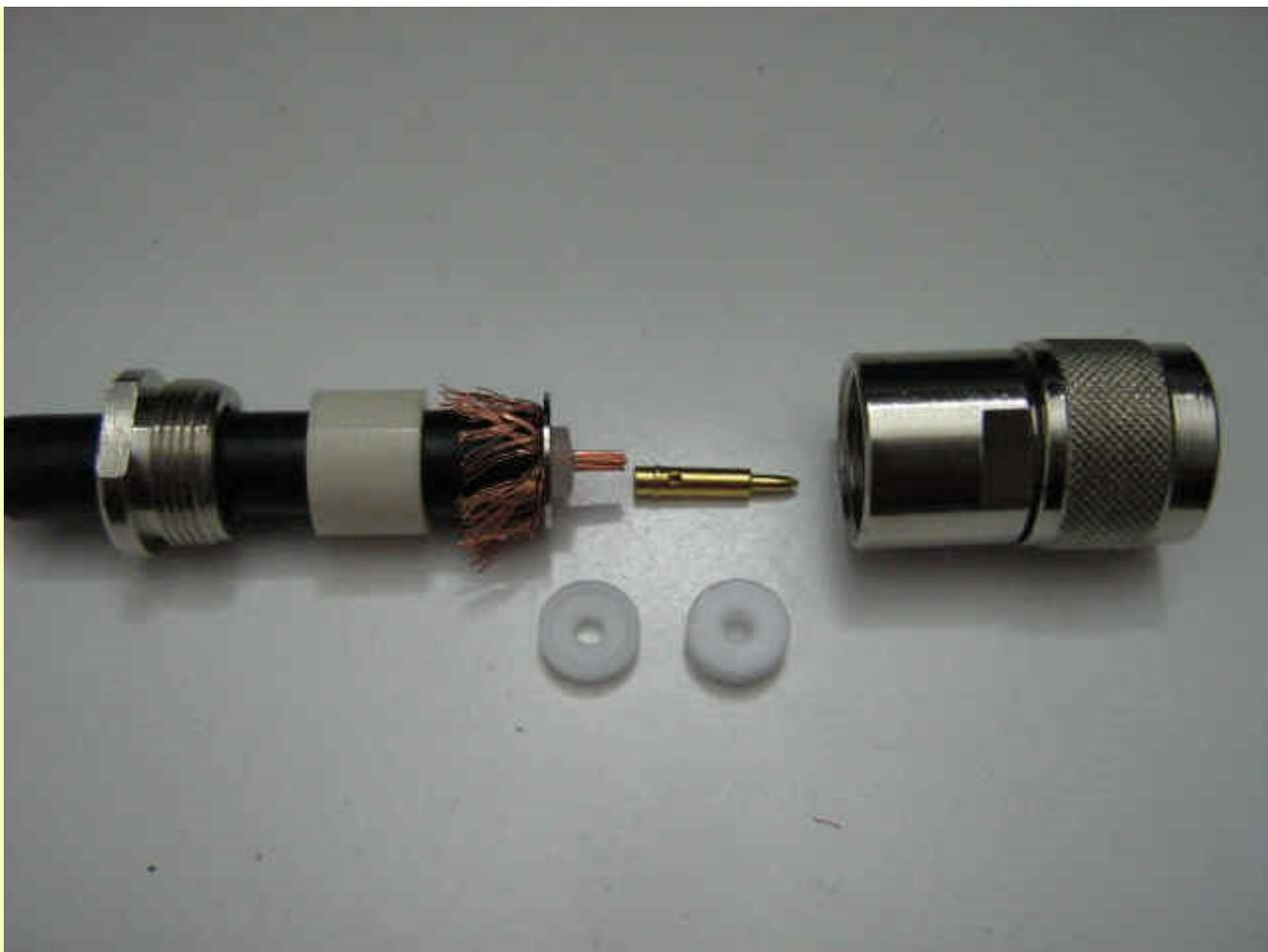
Ultimamente sono disponibili sul mercato connettori il cui montaggio è molto simile a quello dei connettori PL-259 in quanto la calza deve essere saldata direttamente al corpo del connettore. Il connettore N da cavo è inoltre reperibile anche nella versione a crimpare.
