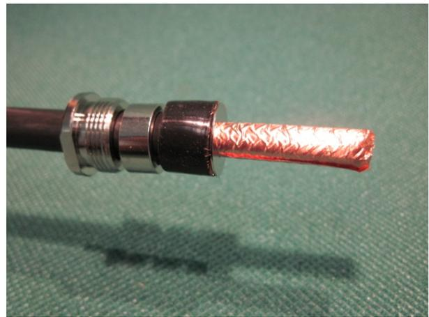
Nella sequenza precedentemente illustrata, diffusa da un noto fornitore tedesco di cavi coassiali, non è stato messo bene in evidenza un passaggio fondamentale per il corretto montaggio del connettore 7378 su cavo tipo **ECOFLEX-10 AIRCOM-PLUS** ecc. La calza deve essere aperta e rivoltata a 90 gradi al livello della guaina nera quindi inserita la ferrula fra la calza e la lamina in rame
