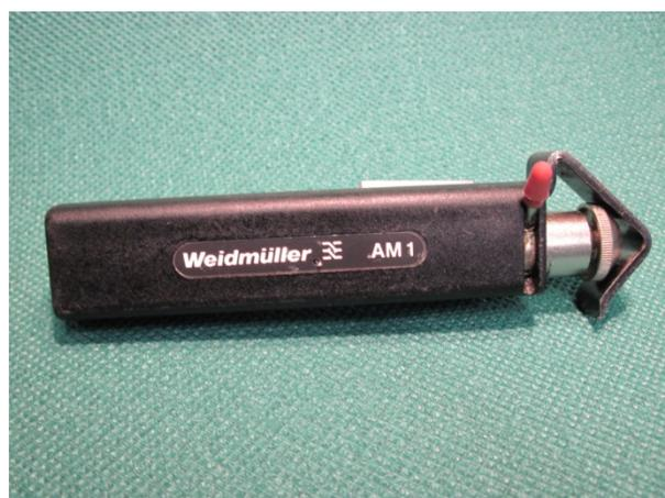
La prima operazione da compiere, dopo aver regolato la profondità di taglio lama dello sguaina-cavo, incidere e tagliare sul cavo sia la guaina in pvc nera esterna che la calza sottostante per una tratto di 30mm, sfilando l'insieme troveremo esposto l'isolante in polietilene (dielettrico) a protezione del conduttore centrale.
