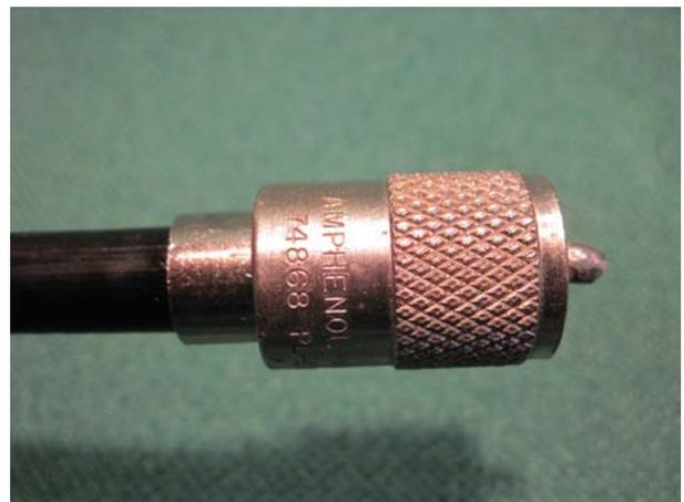
Ricontrollare per sicurezza con un ohmmetro che non ci siano continuità fra il reoforo centrale ed il corpo del connettore, se tutto è in ordine: l'operazione può considerarsi conclusa !
