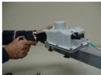
Gli elementi si inseriscono all'interno del tubo in fibra del motor-unit per una profondità di 100mm. Una cuffia in gomma bloccherà gli elementi nella corretta posizione e renderà stagna la chiusura. I motor-unit sono a tenuta stagna pertanto non è assolutamente necessario applicare sigillanti di alcun tipo da nessuna parte.
