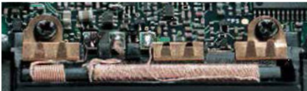
Antenna in ferrite interna per ricezione onde medie e onde corte senza problemi
