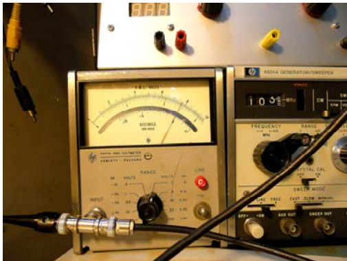
Tensione d'uscita su 0dB a 1000Hz
