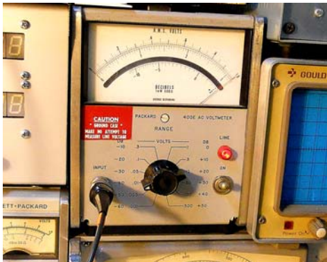
Misura della tensione d'ingresso a vuoto (10mV)...
