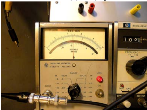
Tensione d'uscita a centro banda (0,47V)
