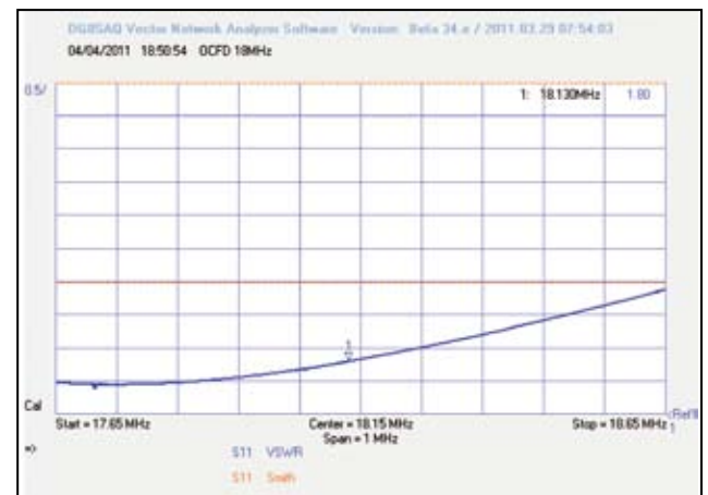
Fig. 14 - SWR misurato dell'antenna in banda 18 MHz
