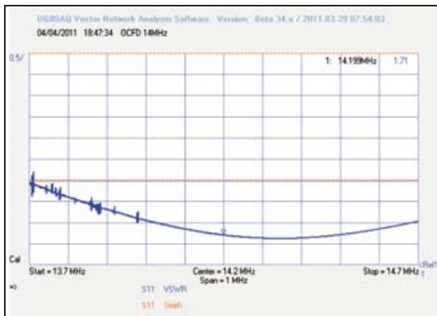
Fig. 13 - SWR misurato dell'antenna in banda 14 MHz. Gli spike presenti non sono errori di misura ma forti segnali in banda
