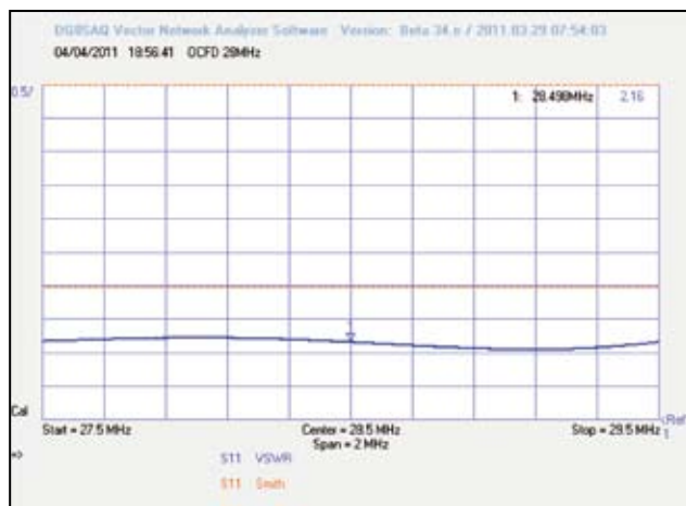
Fig. 16 - SWR misurato dell'antenna in banda 28 MHz
