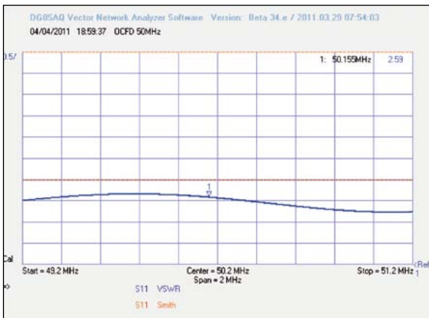
Fig. 17 - SWR misurato dell'antenna in banda 50 MHz
