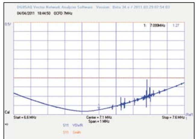
Fig. 12 - SWR misurato dell'antenna in banda 7 MHz. Gli spike presenti non sono errori di misura ma forti segnali in banda.
