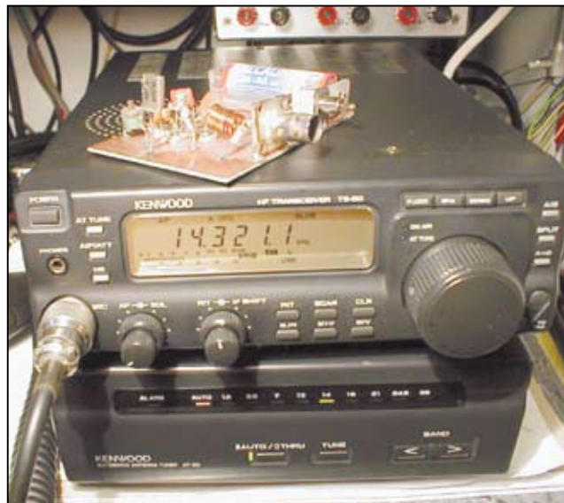
Foto 1 - Il TS50 e il minigeneratore utilizzato
