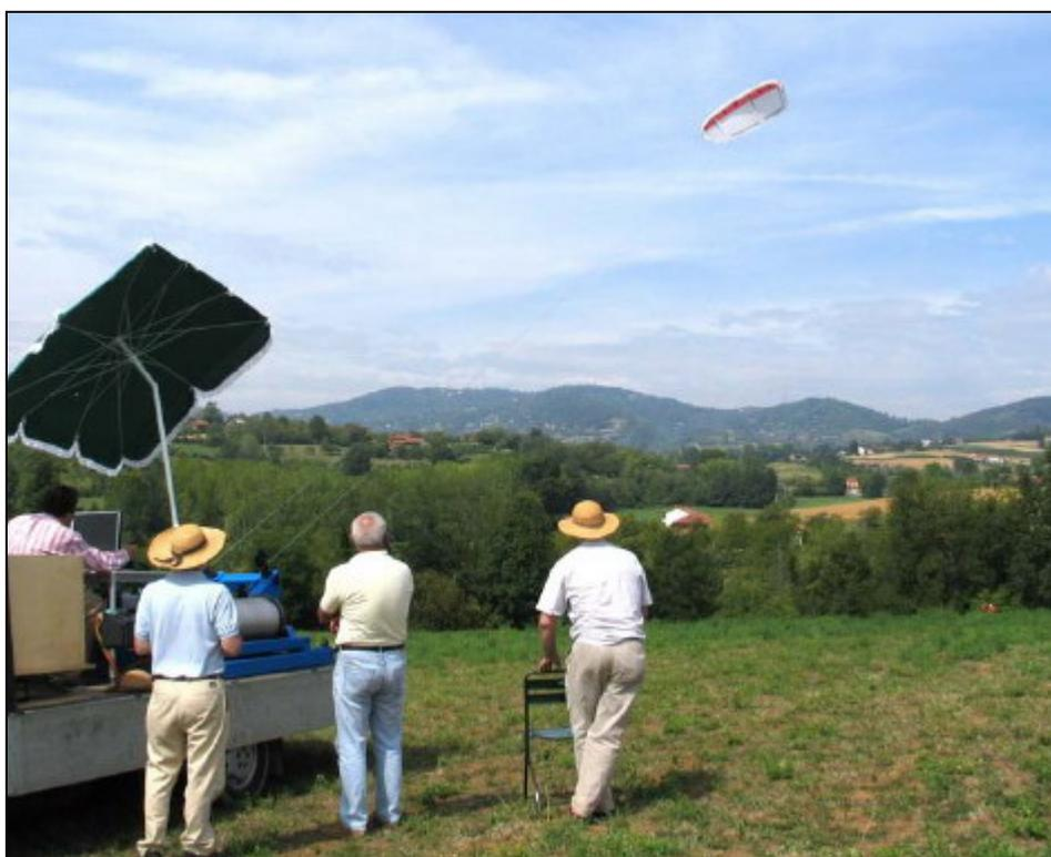
Illustrazione #5: Prototipo KSU1 di unità di manovra KiteGen con una profilo alare standard da kitesurf
