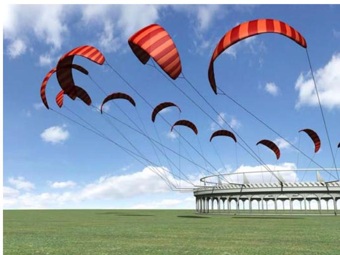
La milestone scelta per fornire la prova del concetto della configurazione carosello, è di costruire un'unità, di potenza approssimativamente 500 kW, collocata su un carrello in movimento lungo un anello circolare ferroviario. In una configurazione modulare, più unità identiche possono coesistere sullo stesso anello, così incrementando la potenza totale al valore di 10 MW. L'area totale circoscritta dal prototipo carosello è 144 ha.
