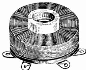
Fig. 36. - Ecco a che cosa si riduce un trasformatore di entrata quando viene usato nei micro-ricevitori universali, senza trasformatore di alimentazione. La figura è in grandezza naturale.
