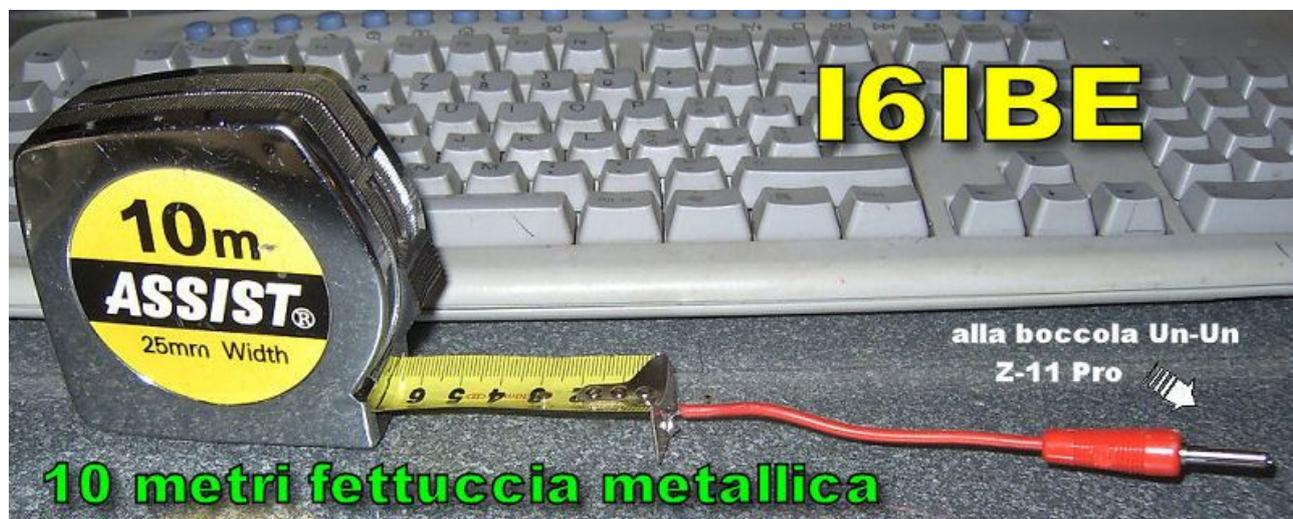
Raschiate la fettuccia metallica ed il battente angolare, un paio di colpi di martello sui ribattini e saldate il tutto a stagno onde stabilire un perfetto contatto elettrico.
