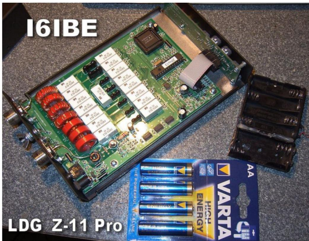
Procuratevi un porta pile da 6 posti per elementi alcalini, deve essere necessariamente piatto, con le batterie disposte su un solo livello, causa spazio molto ridotto. Il collegamento dei fili di alimentazione e' previsto sul circuito appena dietro il jack di alimentazione esterna, due piazzole serigrafate **B - e B +** sono di facile individuazione. Date un'occhiata alle foto per maggiore chiarezza e sicurezza.
