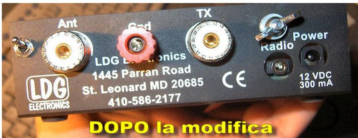
Ecco infine lo Z-11 a lavoro terminato. Siamo pronti per le prove, i test vanno condotti collegando alla boccia di antenna un pezzo di filo elettrico random, 5-10 metri steso alla meno-peggio, attivate l'interruttore e pigiate per più di 5 secondi il pulsante TUNE sul frontale dell'accordatore automatico, partirà un ciclo di accordo che farà risuonare l'antenna nella gamma selezionata dopo pochi secondi.
