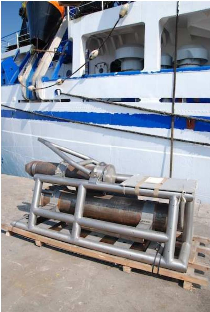
La procedura di deployment del telaio di terminazione del cavo EO è stata testata in acqua bassa con la Nave Certamen
