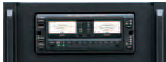
Controller inserito nel corpo dell'amplificatore
