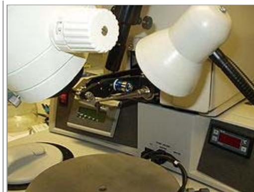
Stazione di saldatura manuale dei sottili fili tra le piazzole del die e i pin del **package**. In produzione la procedura è automatizzata
