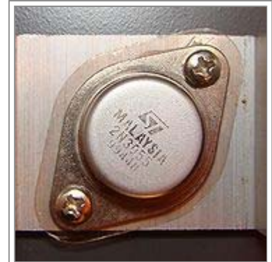
Transistor 2N3055 montato su un dissipatore di calore di alluminio.
