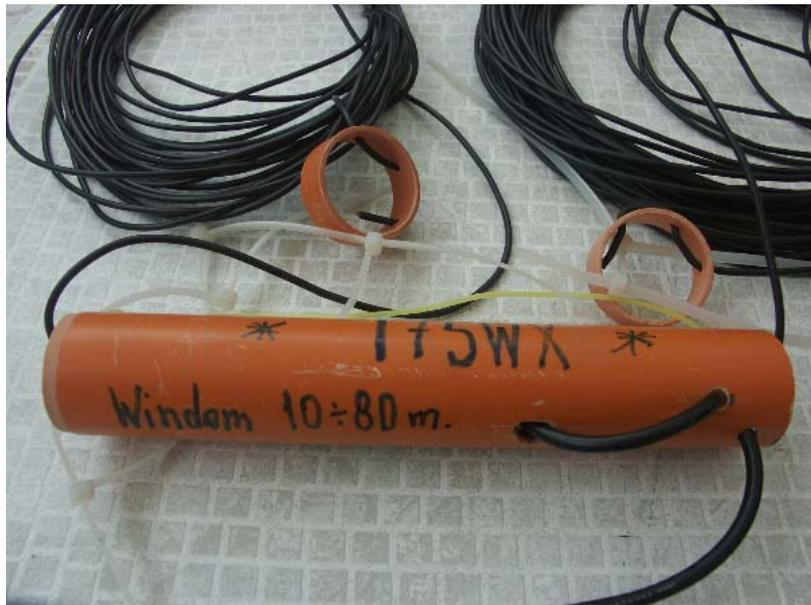
**Figura 5 – Vista del contenitore Balun ed isolatori terminali.**
