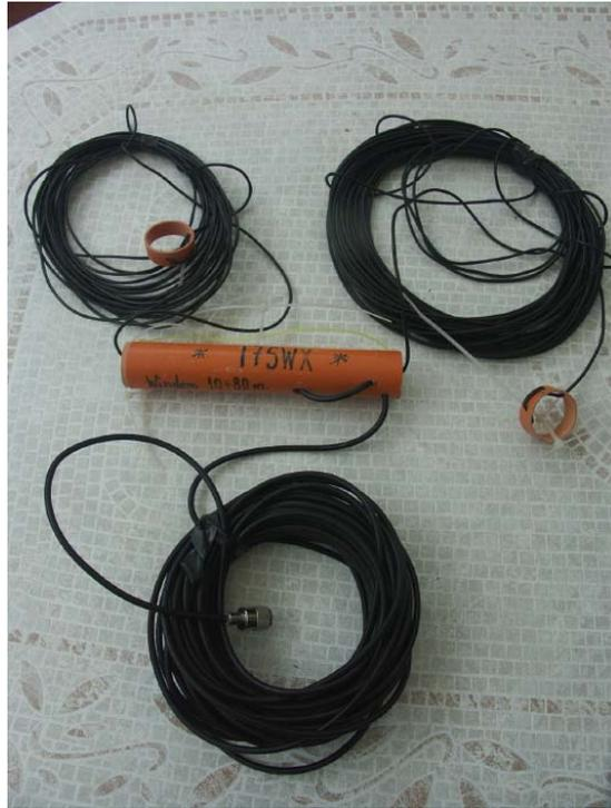
**Figura 4 – Vista di una I7SWX 10-80m Windom assemblata.**
