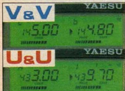
**Esempio di ricezione simultanea di due frequenze sulla stessa banda**
