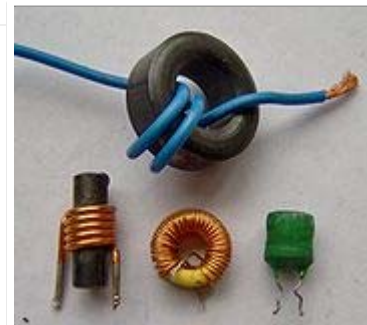
Altri tipi di induttori. Quello in alto e quello in basso al centro sono induttori toroidali
