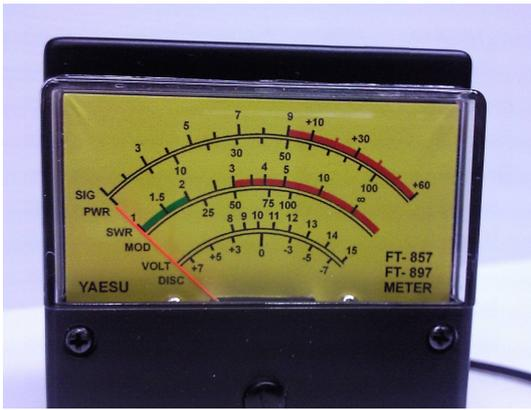
Dopo aver eseguito tutte le connessioni, sono passato alla taratura dello strumento. Alla voce 60 del menù dell'FT-897 c'è il parametro FS che permette di avere in uscita una corrente di 1 milliampere. A questo punto, agendo sul trimmer ho portato la lancetta dello strumento perfettamente a fondo scala. Il gioco è fatto!!!
