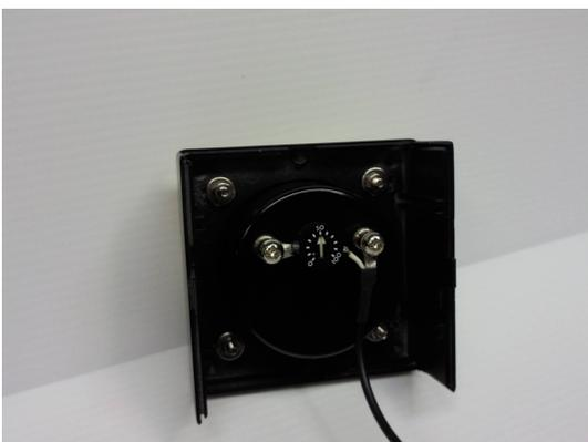
Prima di richiudere la scatola, ho applicato un trimmer del valore di 100 Kohm, tale da consentire la taratura del fondo scala dello strumento. Inoltre ho saldato un jack da 3,5 mm (mono) che servirà per la connessione alla radio.
