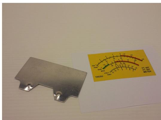
Per non fare trasparire la "vecchia" scala, ho preferito incollarla sulla parte posteriore, usando una colla spray (io ho utilizzato quella che viene impiegata per fissare i puzzle).
