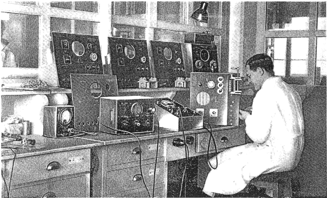
Montaggio d'istrumenti per il controllo della produzione (Ponti elettronici per condensatori).
