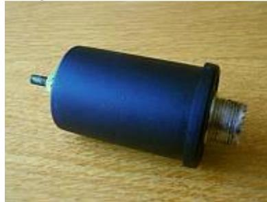
Stesso schema, ma senza GND e 1:1 / 1:2 pin di uscita. Utilizzando un piccolo nucleo, che si adatta comodamente all'interno di un 30 millimetri di PVC filmroll. Un nucleo di 20 millimetri dovrebbero andare bene fino a ca. 15watt.
