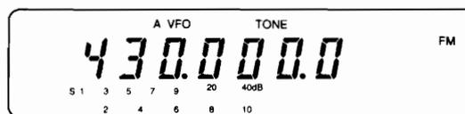
Spesso una frequenza particolare del tono è necessaria per ottenere l'accesso ad un ripetitore. Per esempio, negli U.S.A. o in Canada possono essere necessari 88,5 Hz mentre in Europa vengono utilizzati 1750 Hz. E' possibile selezionare le frequenze del tono elencate di seguito. Sul TM-255E/TM-455E premere il tasto [1750] del microfono per inviare un tono da 1750 Hz.
