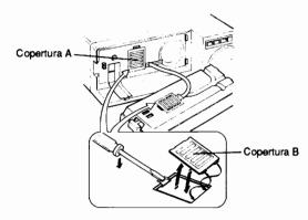
3 Sostituire il cavo di collegamento.
