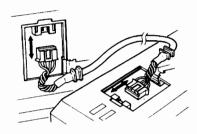
4 Collegare il cavo del microfono (solo DFK-4/DFK-7A). Inserire lo spinotto del cavo del microfono nel connettore del microfono sull'unità principale. Inserire lo spinotto saldamente fino a che la linguetta di bloccaggio non si chiude con uno scatto.
