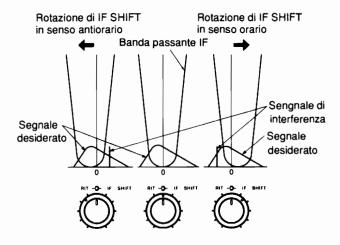
Ruotare il comando **IF SHIFT** in senso orario per eliminare un segnale di interferenza più basso della frequenza di ricezione. Ciò causa l'attenuazione delle interferenze di frequenza più bassa. Ruotare il comando **IF SHIFT** in senso antiorario per eliminare un segnale di interferenza più alto della frequenza di ricezione. Ciò causa l'attenuazione delle interferenze di frequenza più alta.
