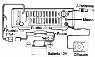
Se il cavo di alimentazione deve essere passato attraverso un foro sul telaio o sulla scocca della vettura, per esempio sulla paratia anteriore dell'abitacolo, utilizzare un passacavi di gomma per proteggere il cavo dall'abrasione. L'intero cavo deve essere preparato in modo che esso sia isolato da colore ed umidità. Dopo aver installato il cavo, avvolgere il portafusibili con nastro resistente al calore per proteggerlo dall'umidità. Fissare l'intera lunghezzza del cavo.
