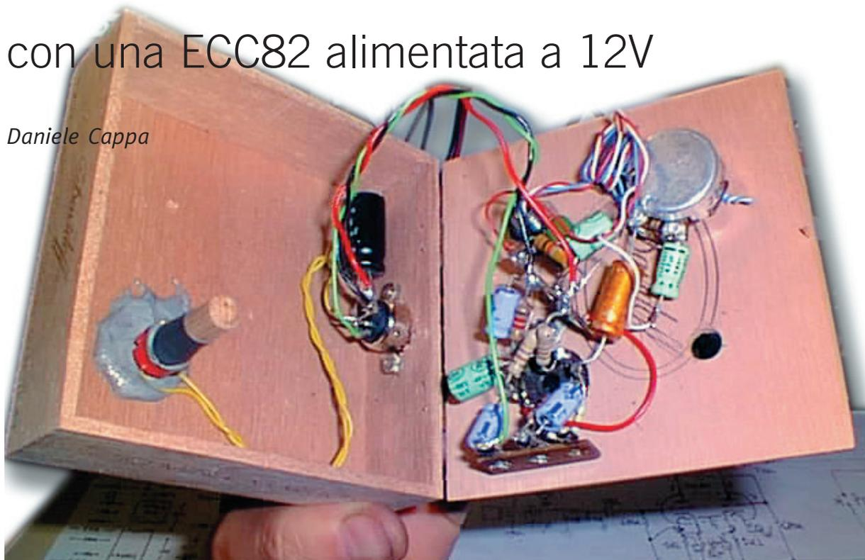
**Uso inconsueto di una vecchia valvola, un preamplificatore microfonico alimentato a bassa tensione da impiegarsi sul ricetrasmittitore**
