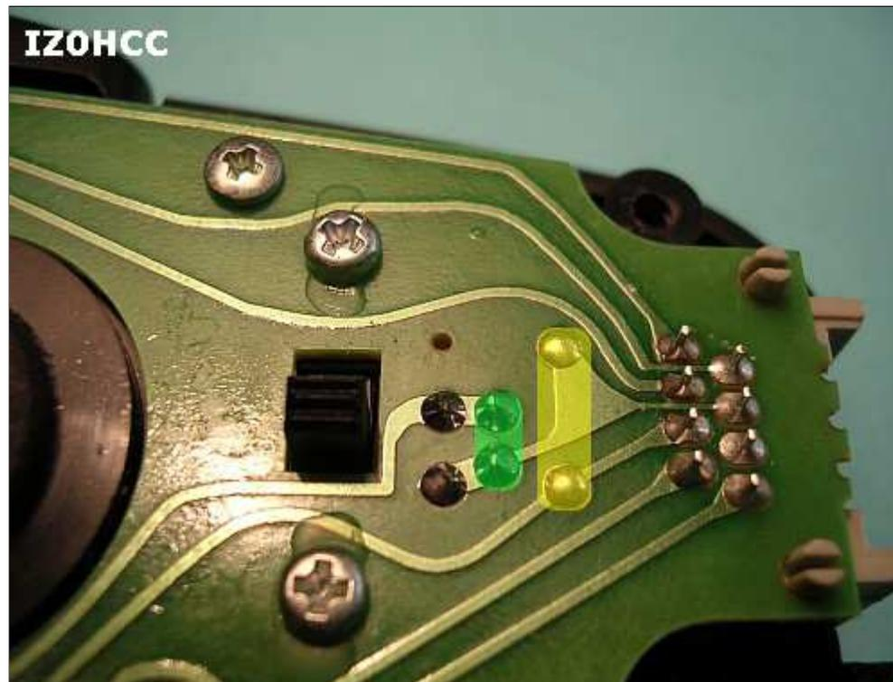
Svitando le tre vitine (non quelle dello switch per il tono) poste sul circuito stampato, possiamo accedere al di sotto (lato saldature) per sostituire il condensatore.
