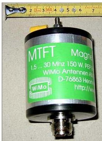
MTFT acquistato dalla [WiMo Antennen GmbH](#) - Si tratta di un balun magnetico con rapporto di trasformazione 10:1 utilizzabile anche in trasmissione fino a circa 150 Watt.
