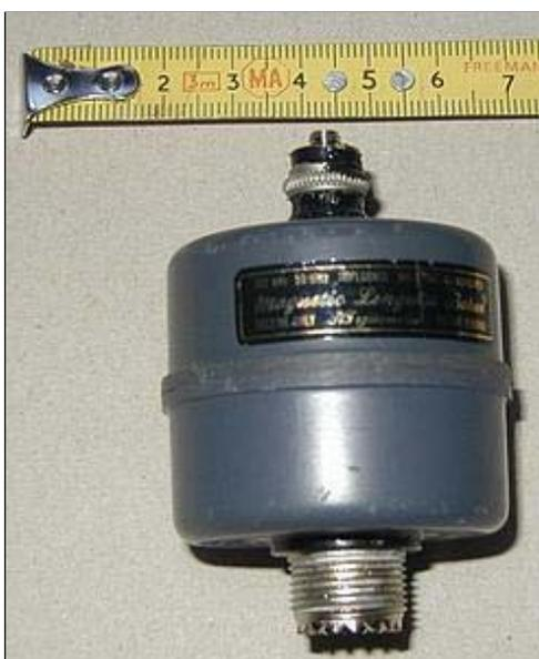
MLB prodotto dalla R.F. System e acquistato da [Hardsoft Products](#) di Chieti Scalo - Si tratta di un balun magnetico con rapporto di trasformazione 6:1 utilizzabile solo per ricezione.
