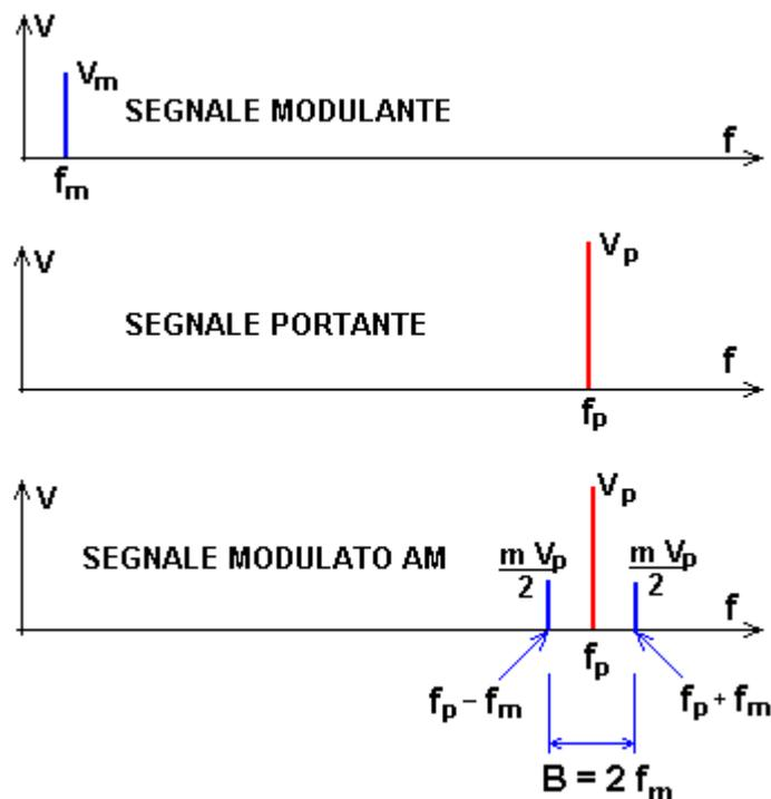
Si osservi come l'operazione di modulazione ha dato luogo ad una traslazione in frequenza del segnale modulante  $f_m$  della quantità  $f_p$ .
