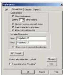
**Allow conferences:** questo settaggio consente di accettare piu' di una connessione con il proprio nodo. Il limite per settare il numero massimo di stazioni permesse, prima di risultare busy, dipende dalla banda in upstream della vostra connessione Internet.
