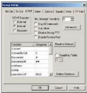
**DTMF decoder:** consente di scegliere se usare o no il decoder DTMF per rendere EchoLink un sistema comandabile a distanza. Qualora si scegliesse di attivare il decoder, si puo' scegliere se questo debba essere di tipo interno (via software) oppure esterno mediante l'interfaccia seriale che pilota la radio. In genere l'uso dei decoder esterni migliora molto la decodifica dei toni DTMF anche in presenza di segnali rumorosi.
