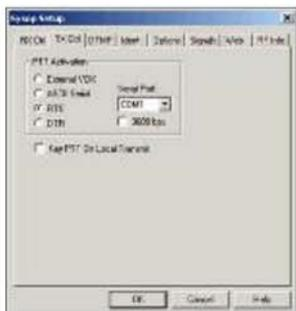
**PTT activation:** questo settaggio consente di attivare il PTT della radio attraverso un piedino della porta seriale o mediante VOX, qualora la radio disponesse di tale possibilita'. La modalita' ASCII deve essere selezionata qualora si utilizzi un'interfaccia di tipo ULIboard o AMIboard. Si dovra' inoltre selezionare la porta seriale a cui e' connessa l'interfaccia radio.
