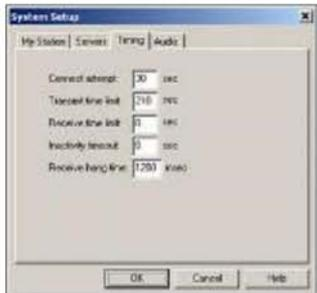
**Connect attempt:** questo parametro setta il tempo massimo per il tentativo di connessione, prima che il sistema dichiari timeout per connessione fallita.
