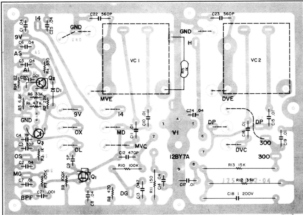
Q1 : 3SK22 (GR), Q2 : 2SC460 (B), Q3 : 2SC535 (A), D1 : 1S1555
