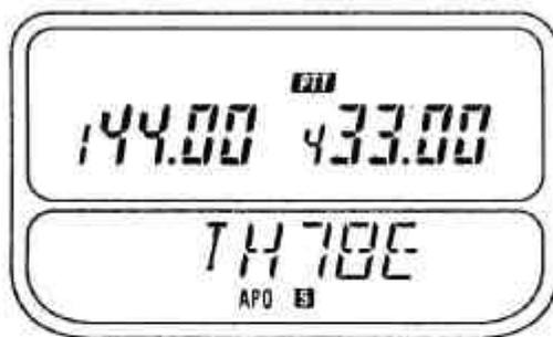
Se i dati del display sono incompleti o le frequenze sbagliate, resettare il microprocessore tramite la procedura illustrata a pagila 87.
