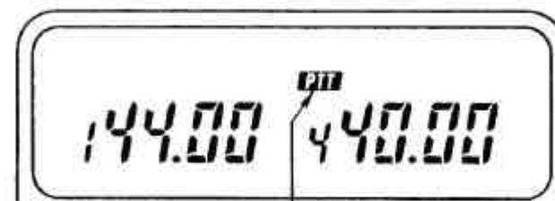
E' possibile controllare la banda per la quale si accende l'indicatore PTT
