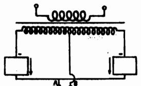
E' possibile semplificare lo schema precedente riunendo i punti B e C, costruendo cioè un trasformatore con un unico secondario ed eseguendo una presa nel suo punto centrale.
