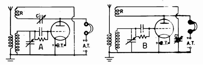
In tutti e due i casi R è fissa ad una determinata distanza dal seccutario. Quando C' è tutto aperto (minima capacità) la corrente ad alta frequenza sarà minima attraverso R e quindi poca la reazione.
