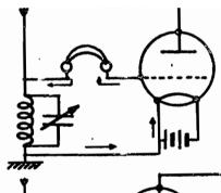
Quando il punto C è positivo, l'armatura del condensatore A caricandosi attrarrà elettroni negativi dal filamento e la corrente circolerà nel senso delle frecce. Nel semiperiodo successivo C sarà negativo e nessuna corrente circolerà.
