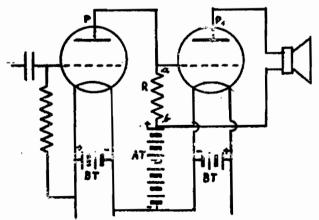
Lei sà che, causa gli elettroni emessi dal filamento, la corrente nella prima valvola (variabile di intensità a motivo delle tensioni applicate alla griglia) circola dalla placca alla resistenza poi alla batteria AT, filamento, placca. Questa corrente continua, tariabile d'intensità in accordo alle oscillazioni applicate alla griglia, nell'attraversare la resistenza R creerà una tensione
