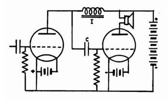
serie alla placca della rivelatrice, si monta un'impedenza, ossia una bobina con nucleo di ferro.
