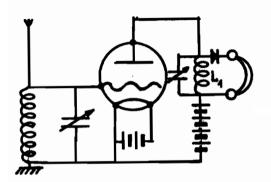
Nel circuito di placca avremo una corrente continua che farà oscillazioni simili a quelle applicate in griglia, della stessa frequenza, ma aumentate in intensità. In questo circuito abbiamo inserito (vedi figura) un'altro circuito di sintonia allo scopo di trasformare questa corrente continua variabile in alternata (più avanti ne comprenderà
