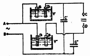
In A e B è applicata la corrente alternata, V' e V" sono due valvole montate in opposizione. C' e C" sono due condensatori da 2 microfarad ciascuno.
