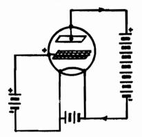
perciò una parte circolerà nel senso filamento, griglia, batteria di griglia filamento, l'altra, passante tra le maglie
