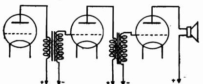
trasformatori intervalvolari, un terzo stadio darebbe un'eccessiva distorsione.
