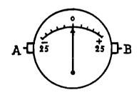
a sinistra, da 0 a 25, sono negative. I capi A e B dello strumento, sono collegati alla corrente alternata che vogliamo esaminare.
