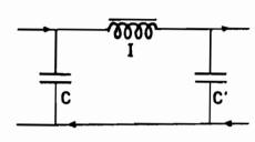
variabile che l'attraversa incontra notevole difficoltà al passaggio, mentre la corrente continua uniforme passa quasi liberamente perchè la ostacola solo la piccola resistenza metallica del filo con cui l'induttanza è avvolta.
