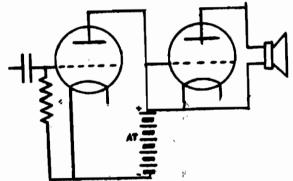
placca della prima valvola è unita direttamente alla griglia della seconda per applicarle le oscillazioni. La placca, però, deve essere collegata anche al positivo della alta tensione per poter funzionare, e quindi, per il momento, ve l'uniremo direttamente.
