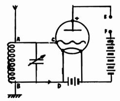
Se A B è il circuito oscillante di sintonia costituito da una bobina e da un condensatore variabile e C e D sono gli estremi di questo circuito applicati rispettivamente alla griglia e al filamento, quando C è positivo la griglia sarà positiva, nel periodo successivo però C sarà negativo e quindi anche la griglia negativa. Ma con griglia positiva la placca assorbirà una quantità maggiore di elettro-
