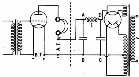
La prima cosa da fare è montare un trasformatore d'alimentazione, una valvola rettificatrice, un filtro.
