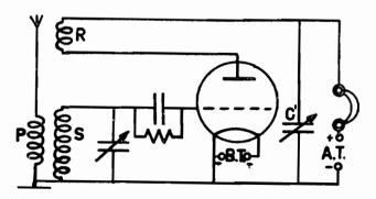
grado di reazione. L'aggiunta del condensatore C' permette di otte nere la regolazione della reazio ne in modo più comodo. Quando C' ha le lamine mobili completamente fuori, cioè ha il minimo di capacità, data una certa distanza di R da S, la corrente ad alta frequenza è limitata nel cirunto di placca dalla impedenza
