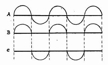
Supponiamo che la valvola, utilizzata per la rettificazione di questa corrente, non lasci passare le semionde negative. Ciò significa che potranno passare solo le positive. Rappresentiamolo graficamente. Basta sopprimere la parte inferiore
