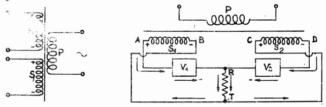
Perciò attraverso R T fluisce corrente, nel senso delle frecce, do-
