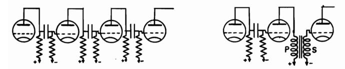
Una buona combinazione è indicata in fig. B che rappresenta lo schema di una valvola amplificatrice montata a resistenza e capacità, e un'altra a trasformatore.
