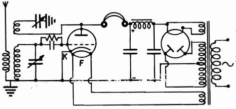
Noterà come il catodo K è collegato al negativo dell'al-ta tensione mentre il filamento è completamente indipendente, ed è alimentato direttamente da un altro seconde rio del trasformatore.
