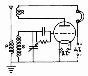
La figura rappresenta un circuito de una valvola rivelatrice con reazione.
