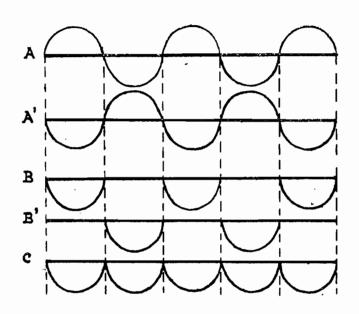
Rappresentiamo graficamente la corrente rettificata col sistema a onda intera. Siano A e A¹ le correnti che alimentano i due circuiti. Siccome un polo di una è positivo quando il corrispondente polo dell'altra è negativo, rappresentiamo il primo semiperiodo di A positivo e il primo semiperiodo di B negativo. In elettrotecnica si dice che le due correnti sono in opposizione di fase.
