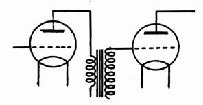
leghiamo il secondario tra griglia e filamento della valvola amplificatrice, le avremo applicato, per esempio, 5 volte la tensione del primario. L'amplificazione che si ottiene così, è superiore a quella dei sistemi precedenti nei quali lavora solo l'amplificazione propria della valvola.
