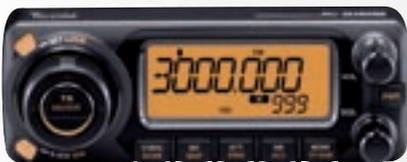
Il pannello frontale separabile con ampio display LCD retroilluminabile in tre colori verde, ambra o giallo in base alle preferenze dell'utilizzatore.
