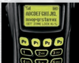
Display LCD a matrice di punti e tasti retro-illuminati.
