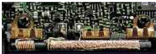
Antenna in ferrite interna per ricezione onde medie e onde corte senza problemi
