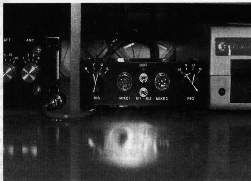
Il deviatore sotto scambia i segnali IN-OUT del registratore sulle due prese micro, quindi il registratore avrà la possibilità di essere connesso all'apparato desiderato, contemporaneamente si può far QSO con un altro RX-TX.
