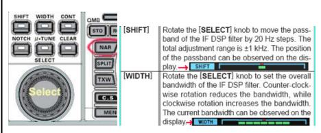
Sul FT-950 **non** c'è il comando [VRF] perchè il Preselector Unit non è più previsto. Il comando IF WIDTH è utilizzato per regolare l'IF DSP bandwidths, mentre con un semplice tocco sul tasto [NAR] si attiva la selezione di valori più stretti "pre-settabili"
