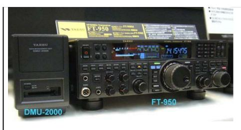
Le immagini a colori, dopo quelle del prototipo, mostrano una ottima linea, con manopole grandi per i comandi più utilizzati e sensibli. Due (VFO Main e CLAR/VFO B) sono come quelle delgli FTdx9000, le altre due (SELECT e AF/RF GAIN) sono di nuovo disegno;
