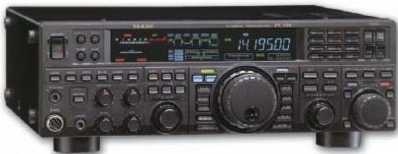
*Nuovo apparato della YAESU lo FT 950 è un ricetrasmittitore per HF – 50MHz classe 100 watt output, alimentazione esterna, dimensioni medie adatto per desk-top, non portatile, con molte facilitazioni operative e altre interessanti fornibili in opzione. Situato commercialmente tra lo FT 450 e lo FT 2000 anche come dimensioni esterne raccoglie molte soluzioni tecniche già presenti sul mod. FT 2000 ed ha una presentazione estetica, quantomeno del display, simile allo FT 450.*
