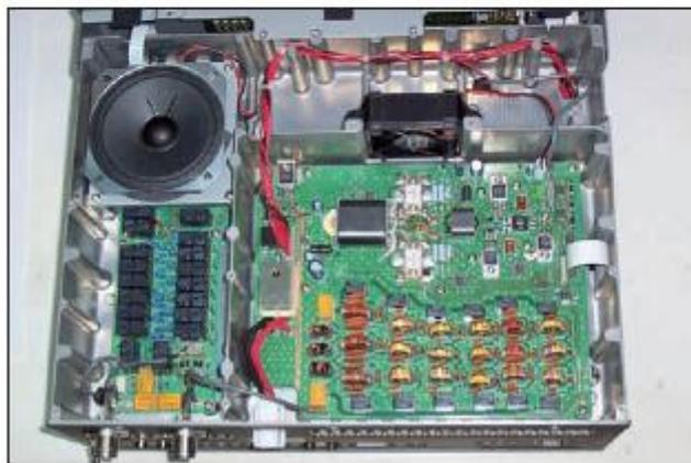
Lato unità di potenza; vista dello stadio con filtri passa-basso; a lato separata dalla parete del telaio l'unità ATU, le bobine sono nascoste dall'altoparlante; notare il telaio pressofuso, la ventola.
