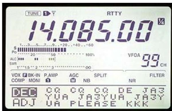
I segnali ricevuti vengono visualizzati in modo alfanumerico direttamente sul display senza bisogno quindi di utilizzare alcuna apparecchiatura esterna.
