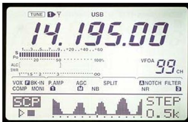
L'ampio visore visualizza il valore della frequenza operativa, il nome del canale con 9 caratteri, il numero del canale nonchè l'intensità del segnale S-meter ed RF, SWR e livello ALC.
