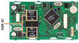
La tecnica evoluta ed i vantaggi del DSP in IF già consolidate nelle stazioni base Icom sono ora disponibili in un apparato per uso fisso e mobile operante in banda HF, 50 MHz, 144 MHz, 430 MHz.
