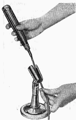
Come si mette il microfono a stilo M 62/A - M 63 nel suo sostegno S 95
