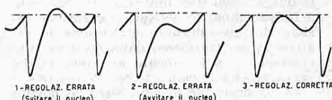
Fig. 46 - Oscillogrammi del segnale presente al terminale n. 6 del trasformatore dell'oscillatore bloccato orizzontale.
