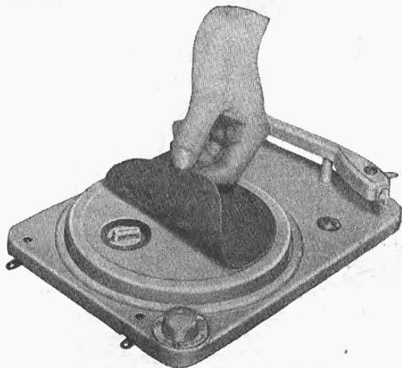
Posizione del cambio-tensioni di rete.
