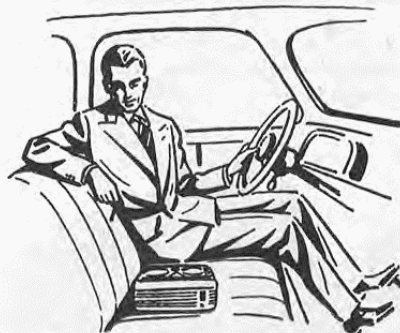
I convertitori a vibratore CC/CA consentono l'uso del magnetofono G 256 anche su automezzi, o in ogni caso là dove è disponibile un semplice accumulatore tipo auto.
