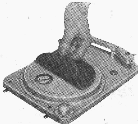
Posizione del cambio-tensioni di rete.
