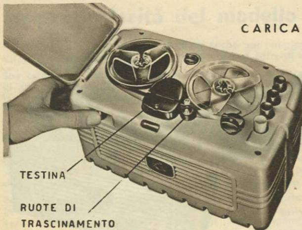
Per utilizzare la doppia traccia invertire e capovolgere le bobine (vedi anche a pag. 23). Per inserire il nastro nell'apparecchio seguire uno di questi due metodi:
