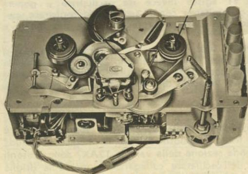
Le altre ruote a rotazione più lenta (in particolare le due di gomma) vanno lubrificate più raramente, con una sola piccola goccia di olio.
