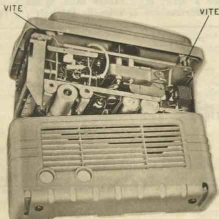
**Attenzione, il telaio è sotto tensione!**
