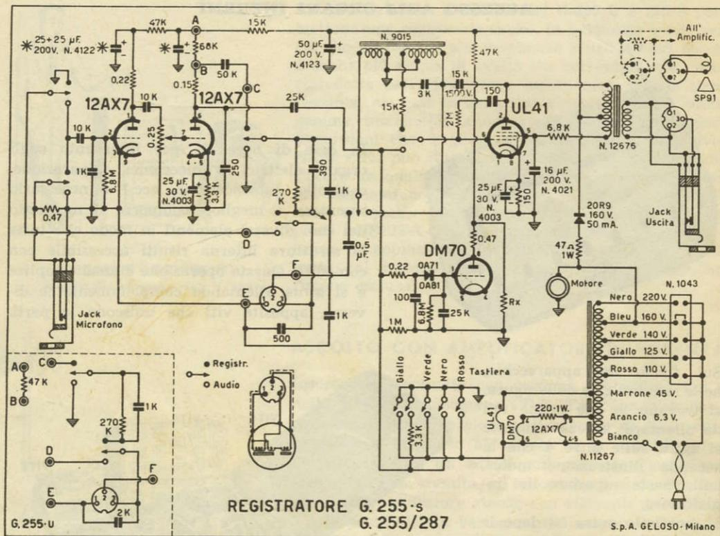
Quando il commutatore è in audizione (tasto verde o giallo premuti a fondo) l'amplificatore è predisposto per fare la lettura del nastro.
