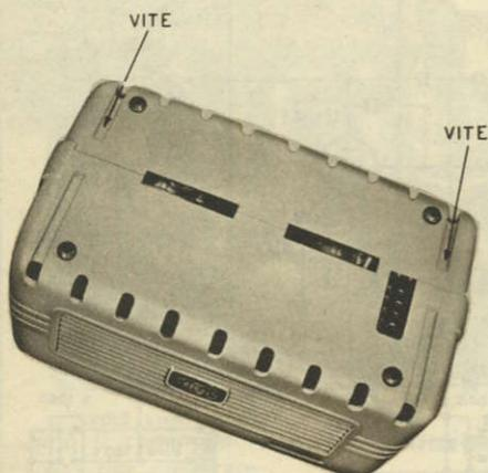
In caso di necessità per intervento sugli organi elettrici o meccanici (riparazione, controllo, lubrificazione, ecc.) è necessario smontare o meglio, scomporre il mobiletto nei suoi diversi elementi in modo che tutta la struttura interna risulti accessibile con comodità. Questa operazione è assai semplice e si attua allentando completamente le diverse, apposite viti che uniscono le parti.
