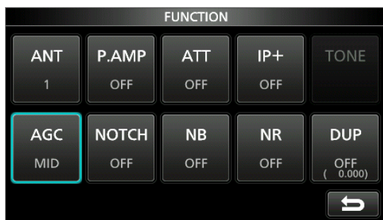
Esempio di schermata Funzione (nella modalità CW)
