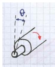
La velocità nel caso di moto circolare può essere intesa come **velocità angolare  $\omega$** , di valore  $\theta / t$  (espressa in rad/s) oppure come **velocità periferica  $v$** , intesa come un vettore tangente e di valore  $\theta r / t$  (espressa in m/s).
