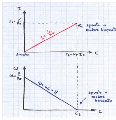
Il coefficiente angolare della caratteristica della velocità rotorica vale  $-H$ ; quindi  $H$  è indice della pendenza della retta. Se osserviamo di nuovo la figura prendendo altri due punti sulla curva:
