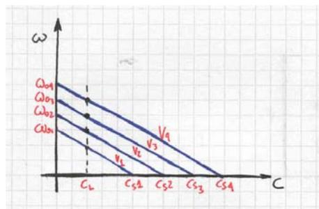
Applicando una coppia  $C_L$  si nota dalla figura che il motore si assesta a velocità crescenti al crescere della tensione di alimentazione.
