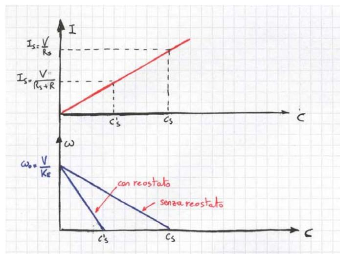
Si noti che la velocità rotoria tende comunque sempre a  $\omega_0$  poichè quella è la velocità alla quale E si contrappone in valore a V, portando il motore a regime; quindi l'inserzione di una resistenza di avviamento non modifica la velocità rotoria a regime.
