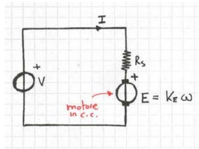
Il motore quindi è come una forza controelettromotrice la cui tensione è dipendente dalla costante  $K_E$  e dalla velocità rotorica; in fase di avvio la velocità rotorica è nulla (motore fermo) e si ha che la corrente è unicamente limitata dalla resistenza serie degli avvolgimenti: tale corrente di valore normalmente abbastanza alto viene denominata **corrente di spunto  $I_s$**  che vale:
