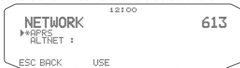
Per trasmettere dati meteorologici, è necessario impostare l'unprotocol: questa impostazione consente di limitare i dati che vengono ricevuti e va utilizzata quando si è all'interno di un gruppo. Selezionare "APRS (APK102)" o "ALTNET". Quando si seleziona "ALTNET", inserire l'ALTNET.
