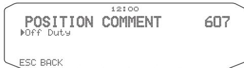
I dati APRS che vengono trasmessi includono sempre uno dei 15 commenti di posizione predeterminati. Selezionare un commento appropriato a seconda della propria situazione.
