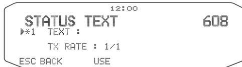
Il testo di stato è un altro commento da trasmettere con i dati di posizione. A differenza di un commento di posizione, è possibile elaborare qualsiasi commento desiderato utilizzando al massimo 42 caratteri alfanumerici. Questo ricetrasmittitore è dotato di 5 canali di memoria per la preprogrammazione.
