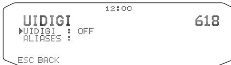
Quando si riceve un pacchetto UI che include il parametro specificato, questo viene sostituito con il parametro MYCALL e il pacchetto viene inoltrato.
