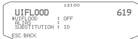
Viene specificata la modalità di elaborazione dei pacchetti UI ricevuti, in cui sono inclusi i parametri WIDEN-N o TRACEN-N. Inserire WIDE o TRACE prima di ID, NOID o FIRST; es. WIDE,FIRST. Con ID selezionato, i digipeater in relay vengono eliminati e viene aggiunto il parametro MYCALL. Utilizzando NOID diminuisce il parametro N-N; es. da 4-3 a 4-2. Utilizzando FIRST il parametro MYCALL viene aggiunto solo in caso di utilizzo come primo digipeater.
