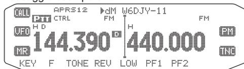
Quando viene ricevuto un messaggio doppio dalla stessa stazione, viene emesso un segnale acustico di errore; tuttavia, viene inviato un avviso di ricezione. Sul display appaiono "dM" e un segnale di chiamata.
